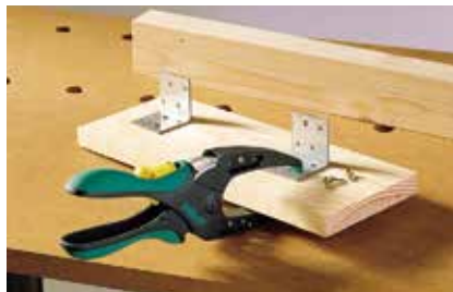
Голямата дълбочина на захвата позволява работата в области, отдалечени от краищата на детайла
