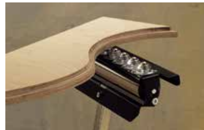
Лагерната основа позволява детайлът да бъде подаван и движан лесно във всички посоки, например при фрезозане
