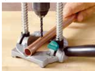
V-образен канал за сигурно фиксиране на кръгли предмети
