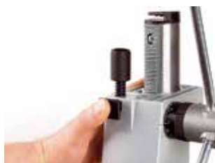
Регулиране на пробиването чрез бързорегулиращ ограничител на дълбочината
