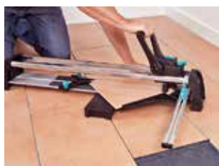
Специален водач за диагонални разрези
