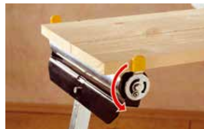
Опорната ролка, монтирана на лагер, позволява материалите да се подават лесно в посоката на обработка
